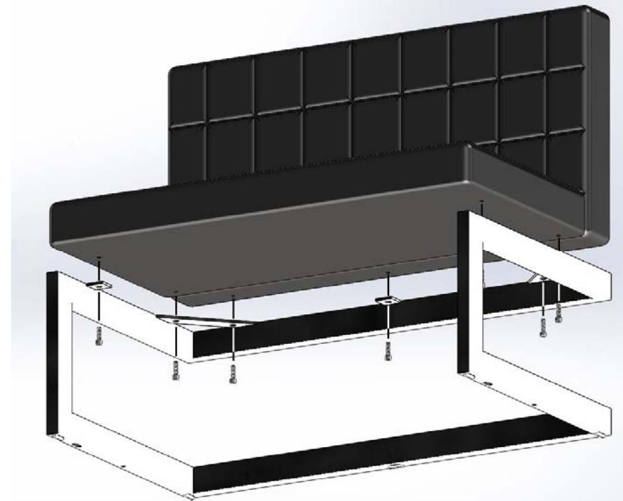
Assemblare 7 viti 8X30 prima le 4 viti del sedile e poi le 3 dello schienale
