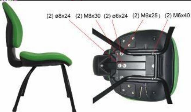
Assemblare la base 4 gambe come nella figura utilizzando 2 viti M8x30 con rondella ø8x24 per lo schienale, 2 viti 6x25 con rondella ø6x24 e 2 viti M6x40 per la base.
