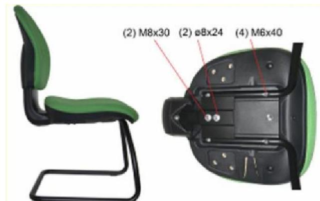
Assemblare la base fissa come nella figura utilizzando 2 viti M8x30 con rondella ø8x24 per lo schienale e 4 viti M6x40 per la base.
