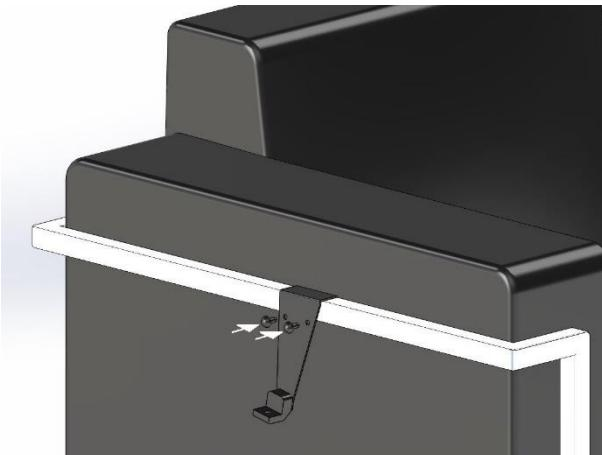
Inserire nella struttura e fissare con n°2 tappi neri
