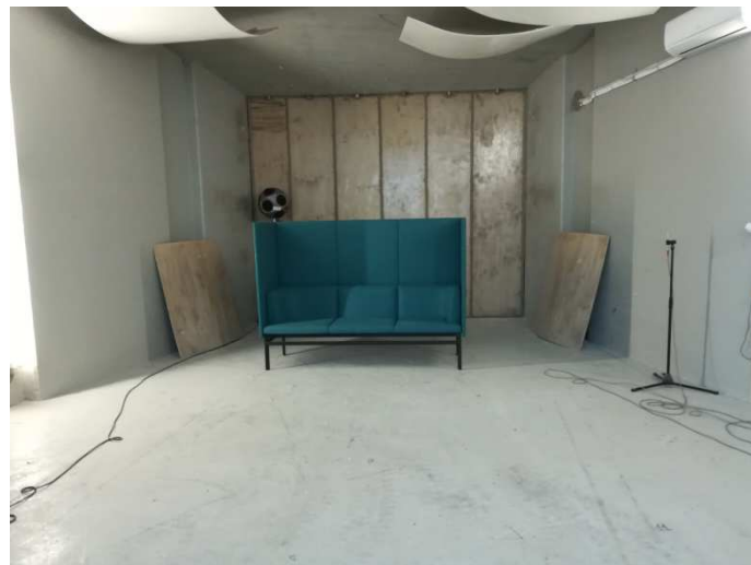
Figura 3_Camera Riverberante con Campione
