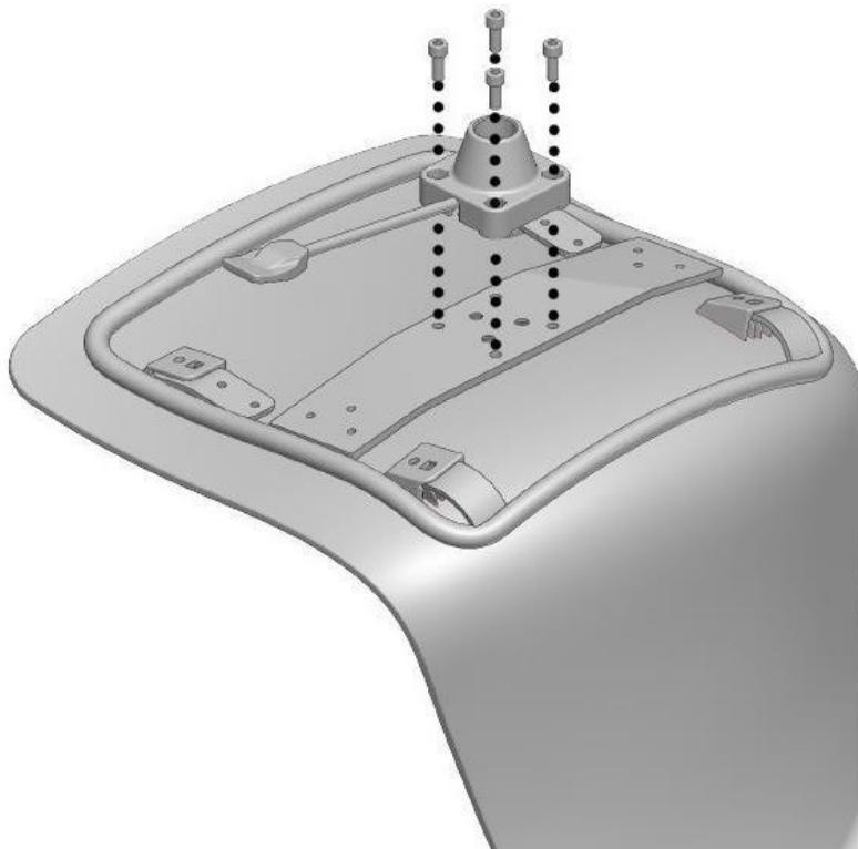
NOTA: Con cacciavite e/o chiave a brugola svitare il meccanismo al telaio. Solo per modelli: EP5T – EP8-9
